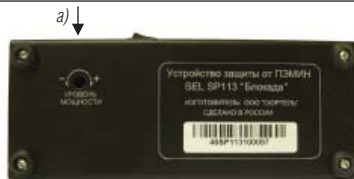
Рис. 4. Нижняя сторона корпуса Устройства а) технологическое отверстие под отвёртку для регулирования уровня мощности шумового сигнала
