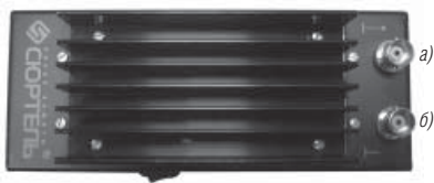
Рис. 3. Верхняя сторона корпуса Устройства а) разъём для подключения телескопической антенны № 1; б) разъём для подключения телескопической антенны № 2.
